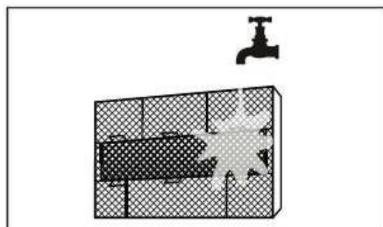
從大型濾網後面取下空氣清新濾網
